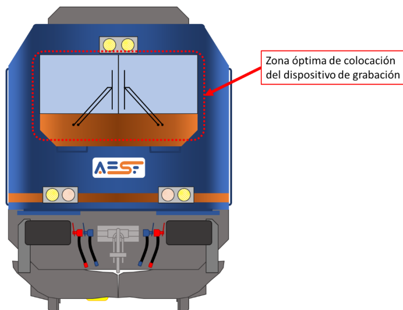
Figura 1: Identificación de la zona óptima de ubicación del dispositivo de grabación por ofrecer una visión más representativa de lo que observa el maquinista desde el puesto de conducción.
