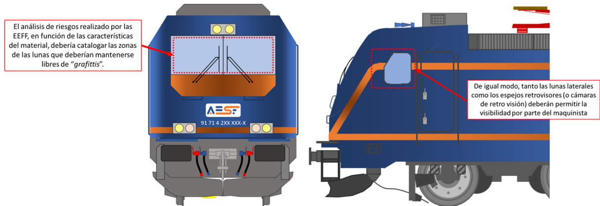
Ilustración 1: Zonas de especial protección para garantizar la correcta visibilidad desde el puesto de conducción.
